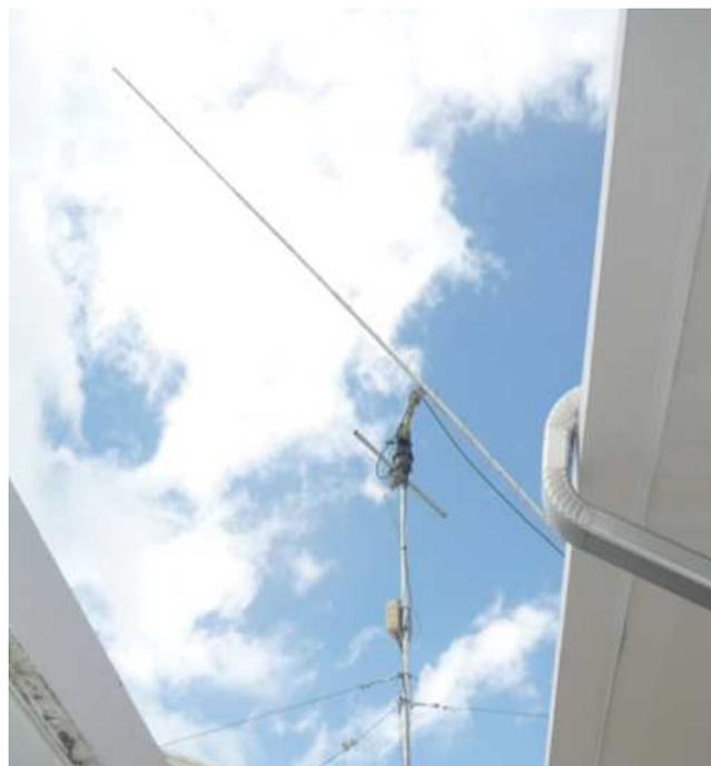
Fig. 4 : L'antenne de la station CRIS-LBO, avec son rotateur et son préamplificateur
